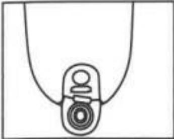
8. Conecte el cable en la toma de carga, luz roja encendida, buena calidad de la carga. La luz verde significa que está lleno.
